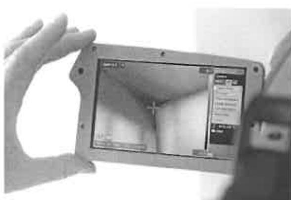
Foto 7-10. Eksempler på optagelser af termografibilleder ved undersøgelse for kuldebroer og utætheder – jf. tidligere fremsendt rapport fra Isolink.
